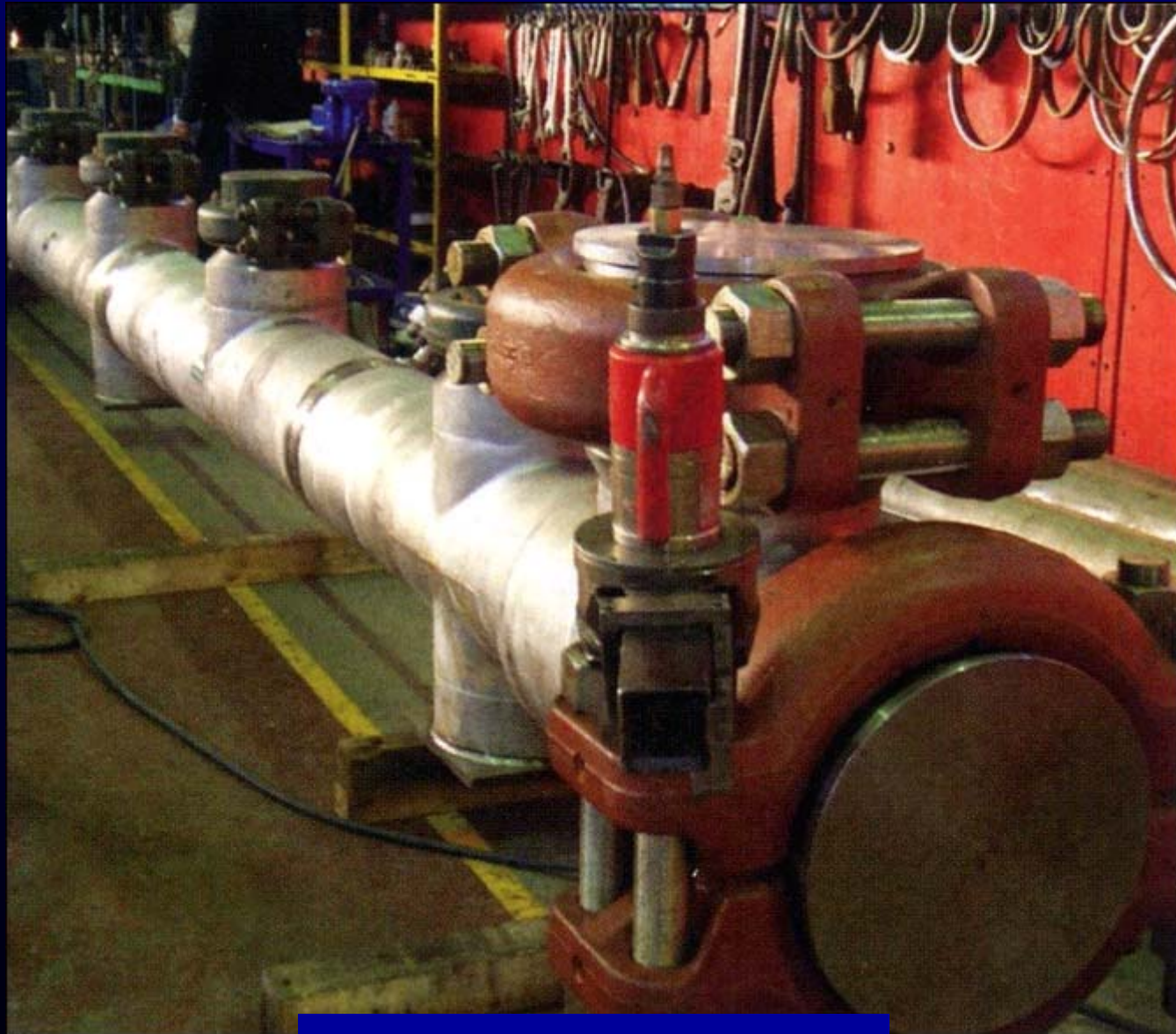
Manifold sin soldaduras
