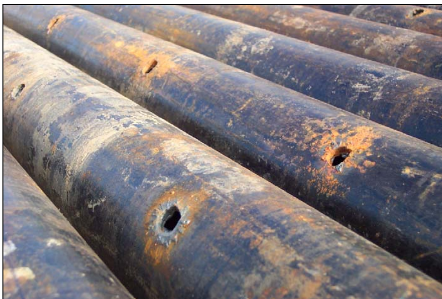
Foto 3: Cañería filtro de 5 pulgadas, preparada en la misma locación.
