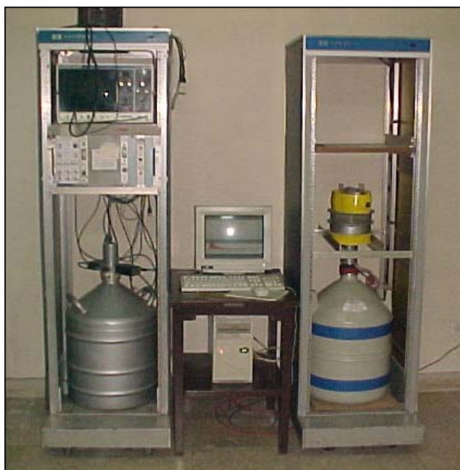
Figura 3: Instrumental para medición de radiación gamma en muestras líquidas.
