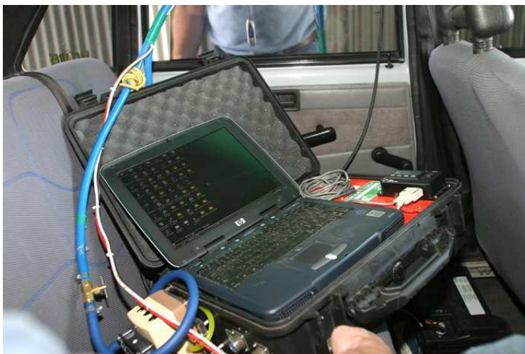
Banco de analizadores en la parte posterior del vehículo (se observan mangueras)
