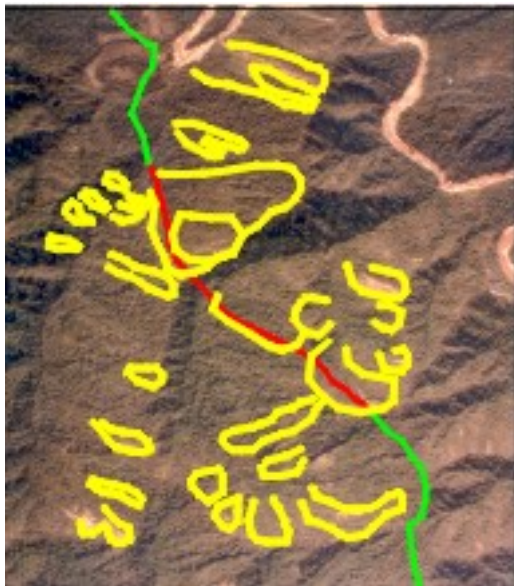
Figura No. 5: Vista de una fotografía aérea tomada en el año 1992, las líneas amarillas muestran los bordes de los deslizamientos, tanto activos como estabilizados al momento de toma de la foto, las verdes indican la ubicación de la picada desarrollada por Bidas para ubicar el gasoducto y la roja señala la probable ubicación de la mencionada picada, esta no aparece en la foto asumiéndose que fue arrasada por los deslizamientos.
