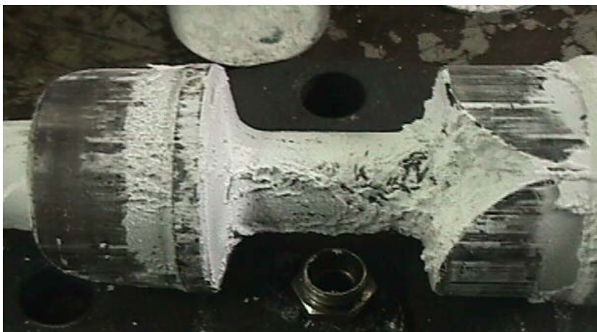
Figura 7: Vista de interno de válvula de control cubierto con \text{NH}_4\text{Cl}
