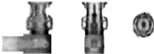
Fig. 2. Cortes cartesianos de la tomografía del conector BNC
