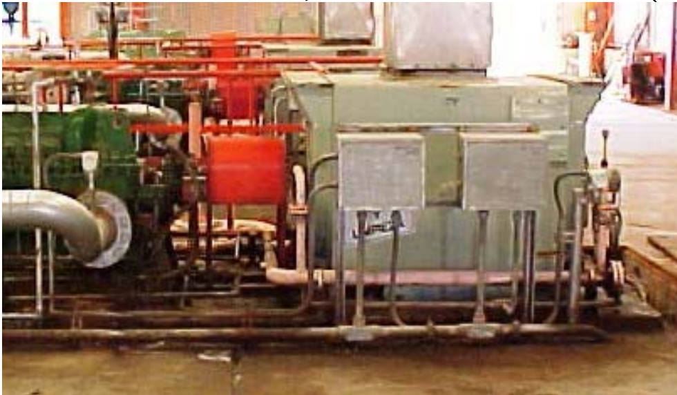
Foto de un motor eléctrico Ruso, cañerías del sistema de lubricación (color rosa)
