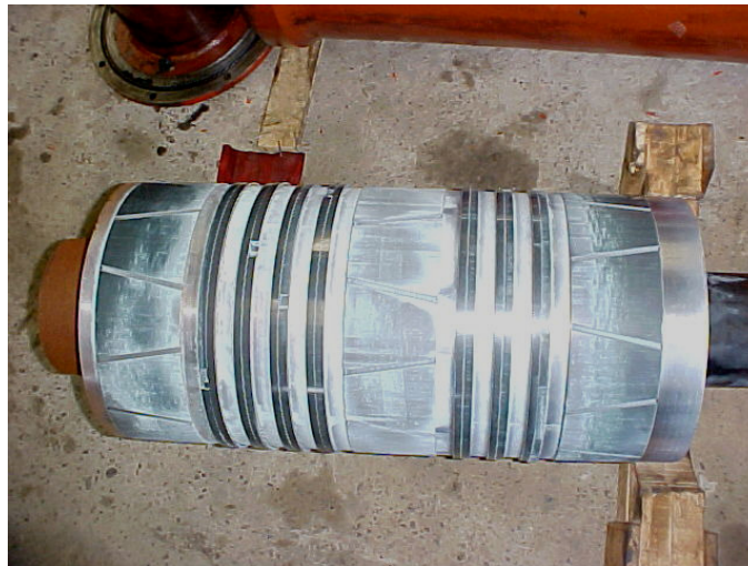
FIG 5: Pistón con aros de compresión y fajas guía de polímero
