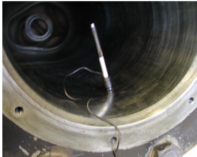
FIG 4: Medición de rugosidad superficial en cilindros
