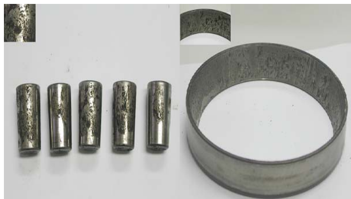
Figura 12. Detección de falla de rodamientos de toma de fuerza por ultrasonido
