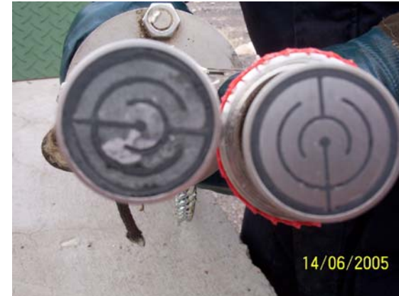
Se observa, la corrosión de la probeta en la parte blanca. Al lado una probeta nueva para comparar.
