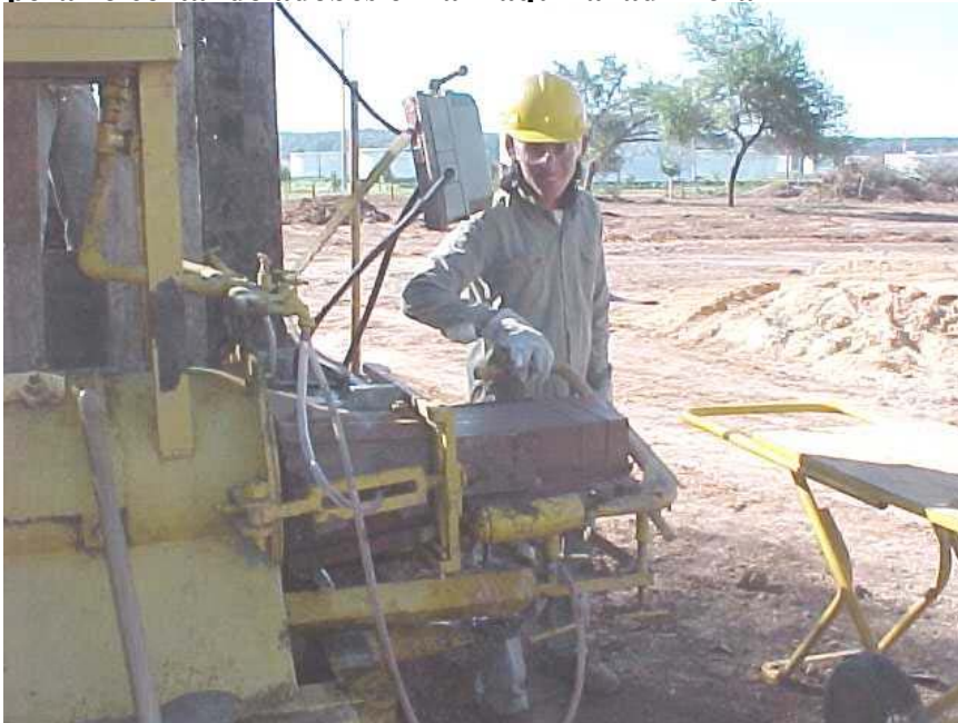
Operario cortando adobes en la máquina ladrillera
