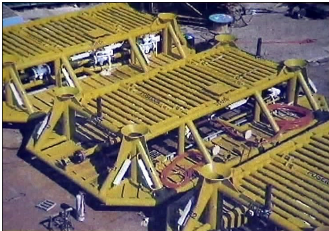
Fig. 10 Estructuras de Protección de los Distribuidores Submarinos
