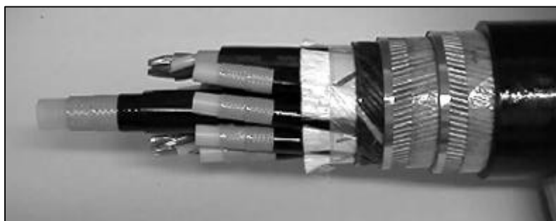
Fig. 7 Sección del Umbilical Principal
