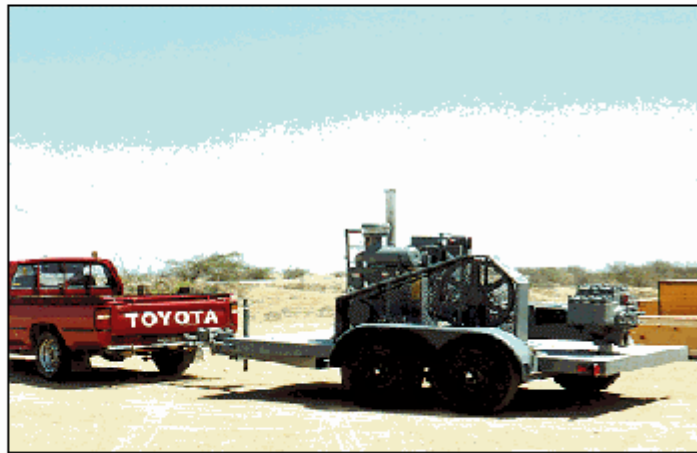
Figura 5. Bomba portátil de transferencia
