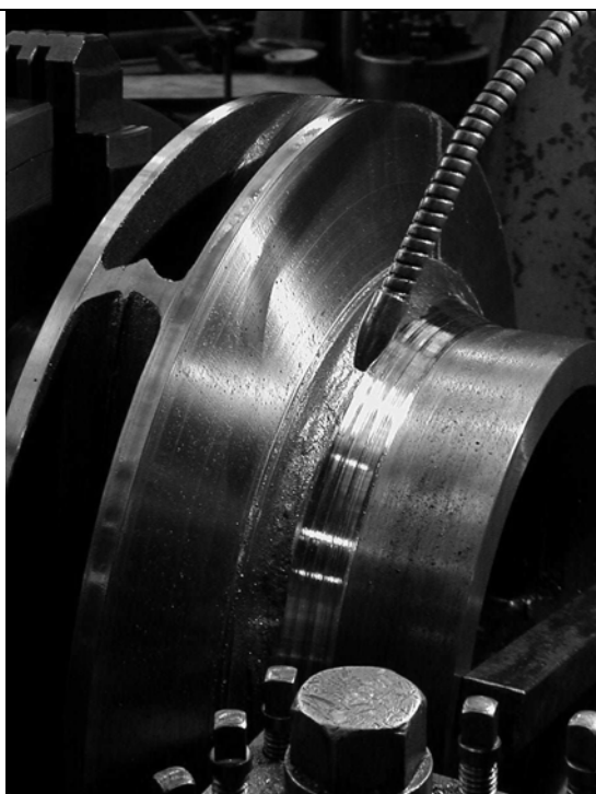
Figura 18. Resultado del análisis. Construcción de un nuevo rodete.
