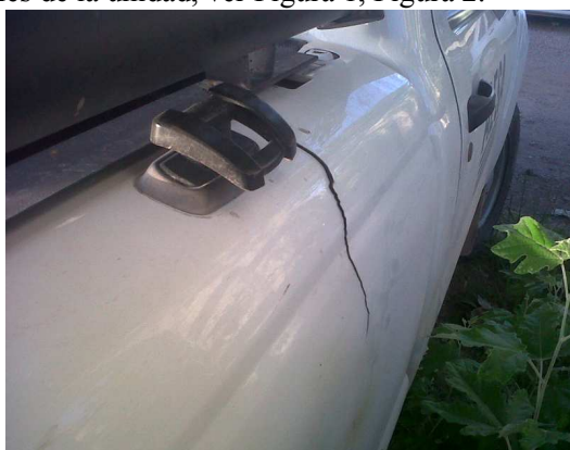
Figura 1 Ruptura de la caja de carga
