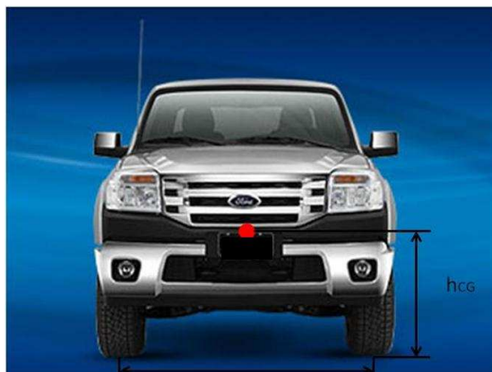
Figura 21 Cálculo del factor estático de estabilidad
