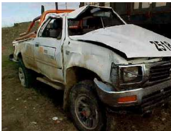
Figura 8 Deformación en una pick up siniestrada (lesiones graves) [3]
