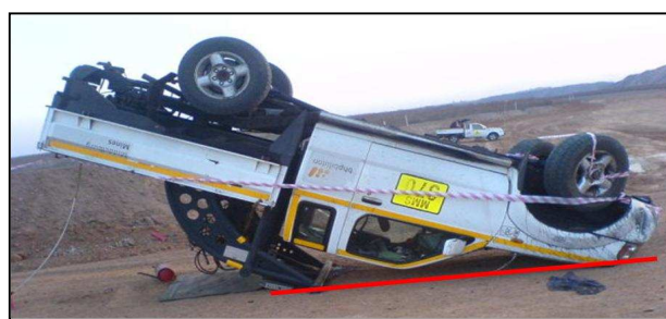
Figura 34 Punto de apoyo de ROPS Diseño 3 [15]
