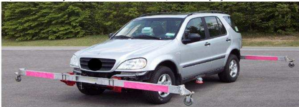
Figura 25 Vehículo preparado para pruebas de estabilidad [10]
