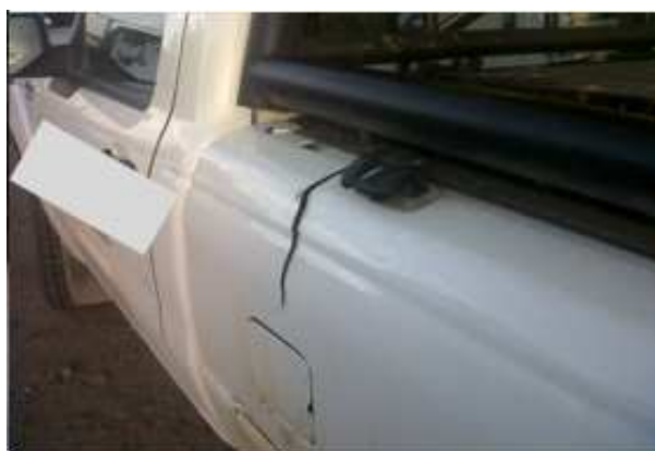
Figura 2 Ruptura de la caja de carga
