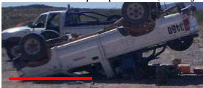
Figura 9 Aplastamiento de la cabina desde la barra externa hasta el frente del vehículo [3]
