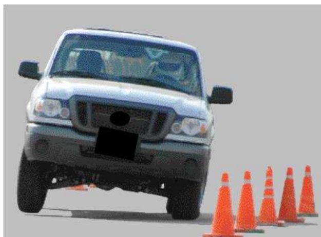
Figura 27 Prueba ISO 3888-2 sobre una pick up [11]
