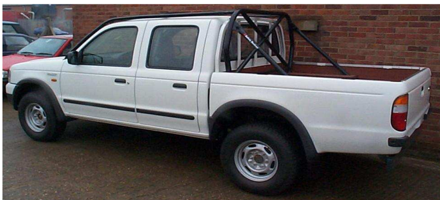
Figura 31 ROPS Jaula Externa Inglesa (Diseño 2) [14]
