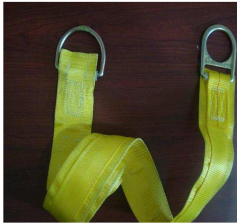
Foto 8. Eslinga sintética para anclajes con capacidad de 5000 lb.
