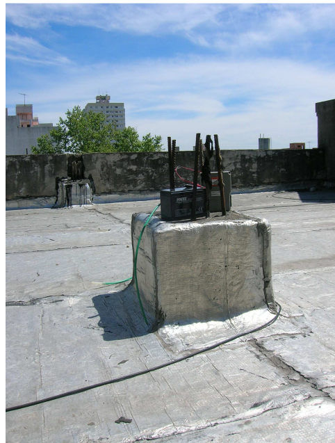
Foto 3: Bomba Minipump marca Sibata Sigma 30 y tubo de coconut utilizado para el monitoreo de COV's
