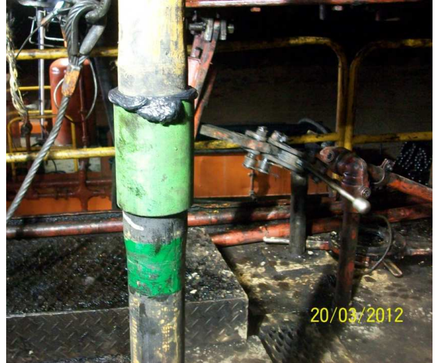
Fig 5: Grasa exudada en conexiones de OCTG.
