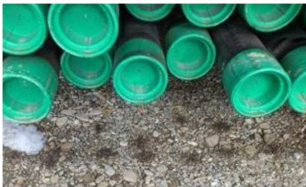
Fig 12: Contaminación de suelo con restos de grasa por lavado de roscas estándar.
