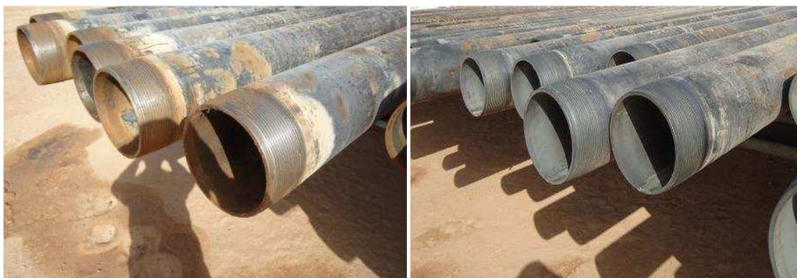
Fig 11: (Izq.) Contaminación de suelo con restos de grasa por lavado de roscas estándar. (Der.) Casing con conexiones con Tecnología Dopeless® sin contaminación alguna de suelo.
