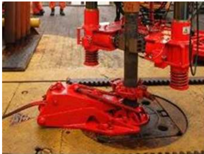
Fig 6: Piso de trabajo sin residuos de grasa por el uso de tecnología Dopeless®
