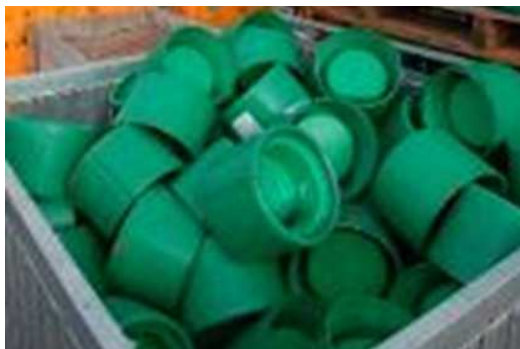
Fig 13: Los protectores Dopeless® luego de removidos de las conexiones están listos para ser reusados o reciclados.
