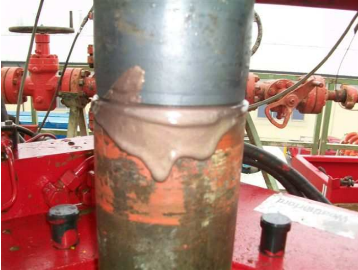
Fig 5: Grasa exudada en conexiones de OCTG.
