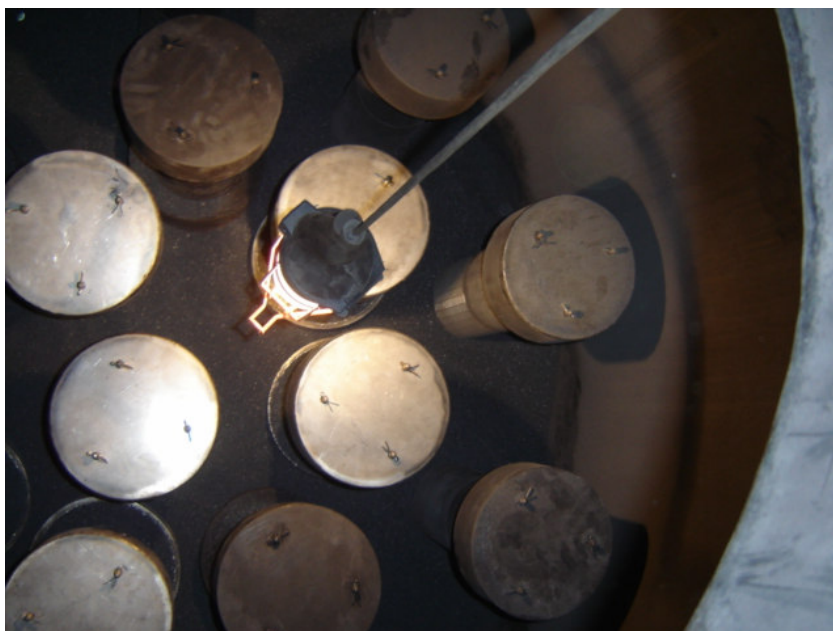
Foto 4 – Canastillas colocadas en la parte superior del reactor
