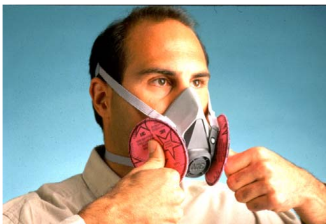
Figura 12: Prueba de campo "presión negativa"
