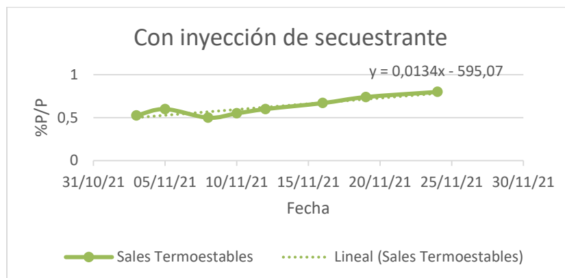
Imagen 6 – Tendencia de formación de sales termoestables con inyección de secuestrante de oxígeno.
