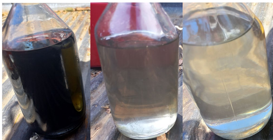
Imagen 4 - Muestra de Amina de izquierda a derecha: 17/12/21, 20/12/21, 22/12/21
