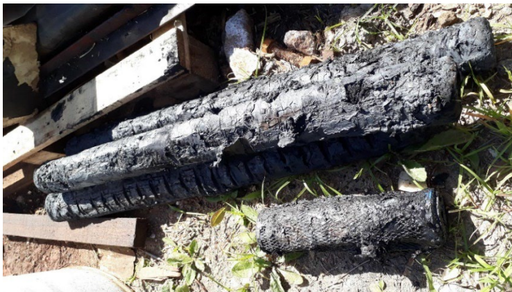
Imagen 1 – Filtros de 20 µm removidos con gran cantidad de depósitos grasos.
