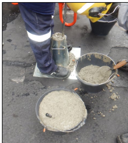
Imagen 23: Fotografía de ejecución de probetas
