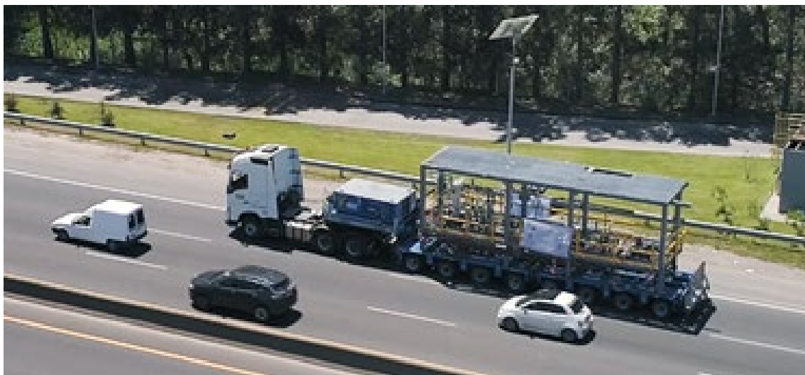
Ilustración 8 - Módulo de la unidad de PFU en transporte.
