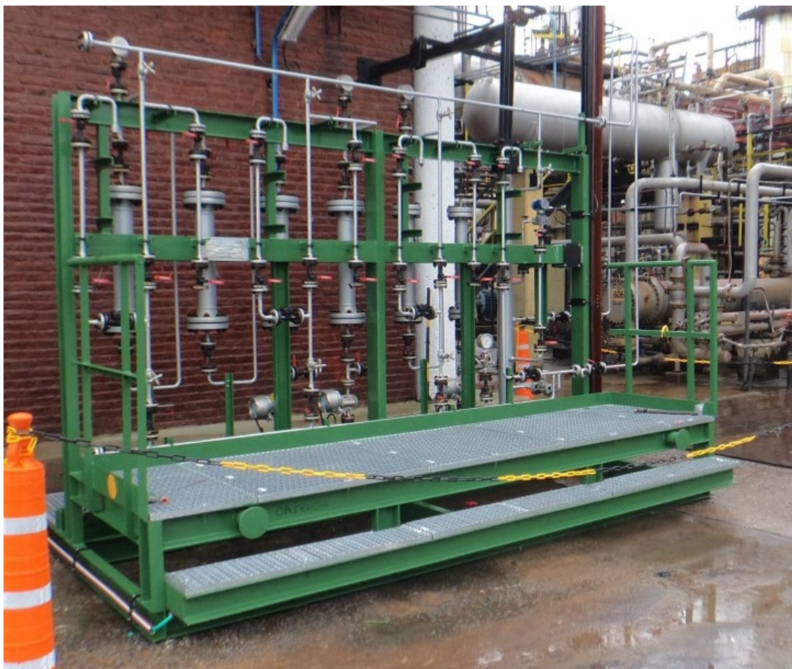
Ilustración 3 - Planta Piloto para prueba de adsorbentes.
