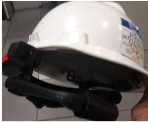
Fig. 4. Posee parlantes, micrófono, cámara y una micro pantalla integrados.
