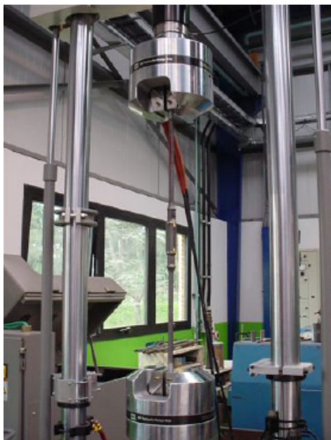
Fig. 5—Máquina de ensayos a la fatiga a plena escala.
