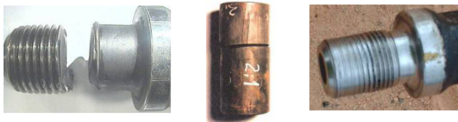
Fig. 1—Problemática de fallas observadas en el campo con diseño de rosca convencional.
