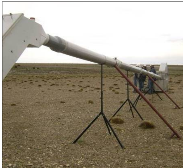
Figura 31 Tubo colector estaqueado
