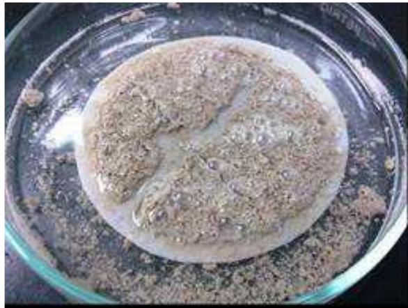
Figura 8. Desprendimiento de sólidos de la retorta lograda con la acción combinada de un colchón base surfactante y otro ácido.
