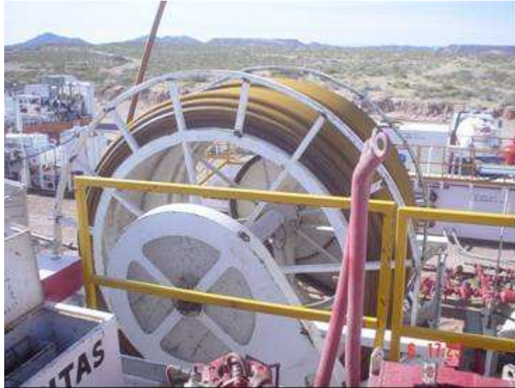
Figura 1. Carretel de CT 2 7/8" montado en el equipo ECFrac.
