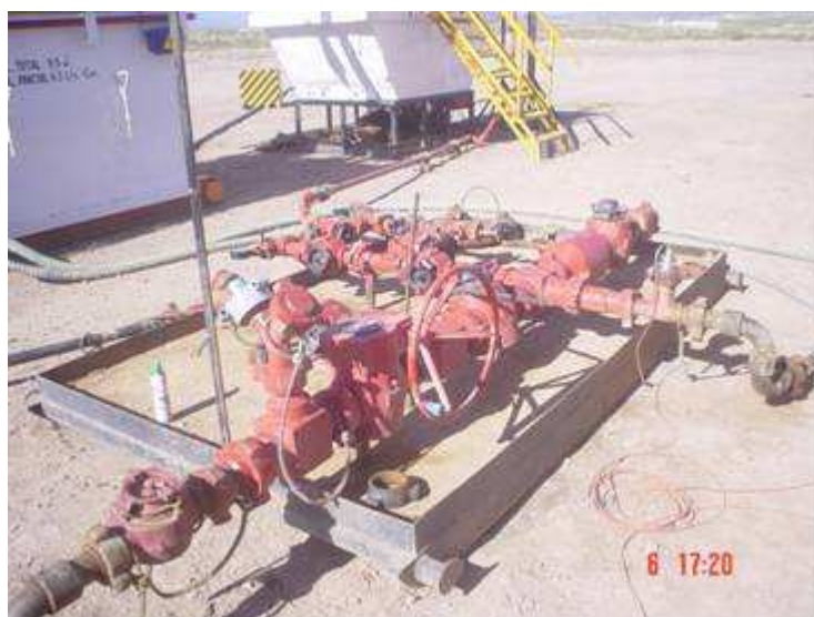
Figura 4. Choke manifold del equipo con dos cajas porta orificio para ensayos pos-fractura.
