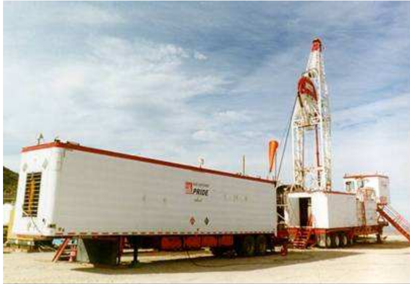
Figura 3. Trailer usina del equipo ECFrac. Potencia disponible de 413 KW .
