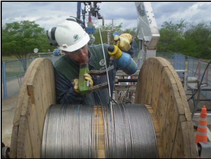
Foto 2: Muestra realizada con Partículas Magnetizables
