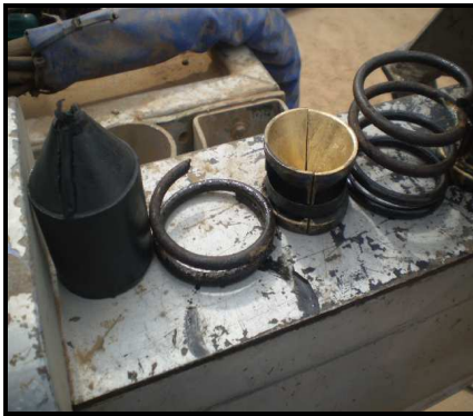
Foto 7: Despiece del Pack-Off Desmontado del Pozo
