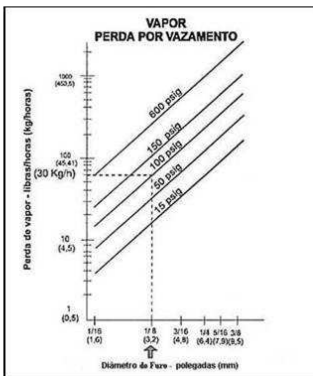
Figura 3.2 - Gráfico de perdas de vapor em relação ao diâmetro do furos para diferentes pressões de operação.
