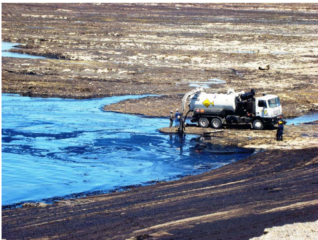
Figura 8: Uso de camiones del alto vacío.
