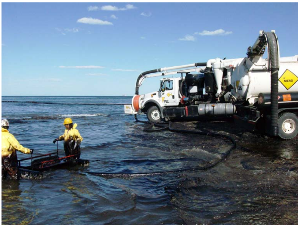
Figura 9: Uso de camiones del alto vacío asociados con skimmer.
