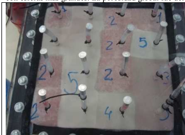
Fig. 8: Celda heterogénea con 5 calidades de relleno. La coloración indica las saturaciones relativas de agua y petróleo al inicio de los barridos.
