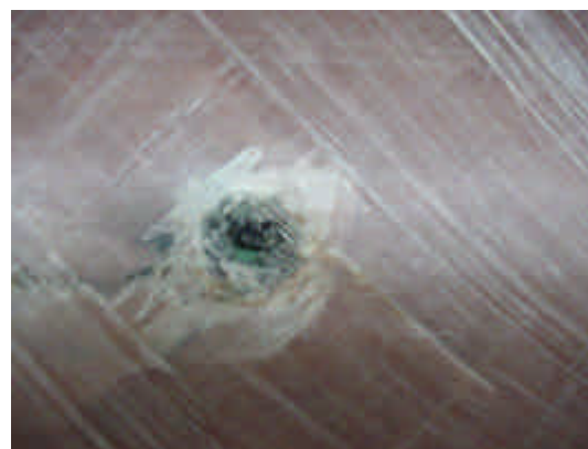
Fig. 3: Interior cañoneado con Cañón Ø 4" 4 tiros por pie, 22 gr.
