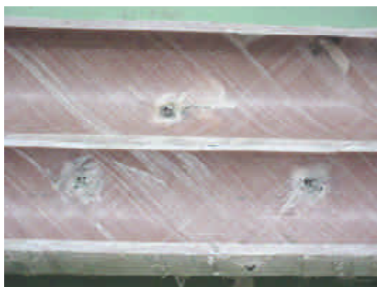
Fig. 3: Interior cañoneado con Cañón Ø 4" 4 tiros por pie, 22 gr.
