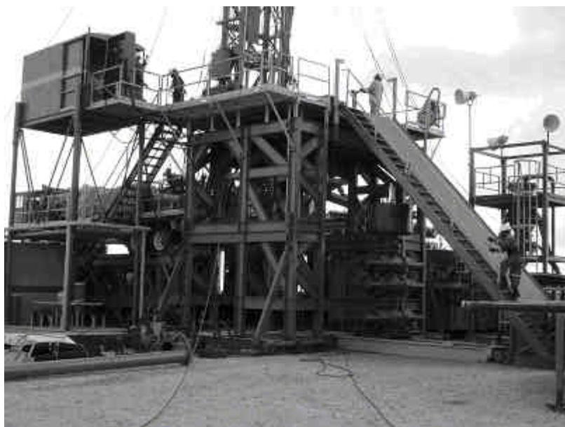
Figura N° 7. Equipo de Perforación utilizado en la Campaña. Conjunto de Preventores.
