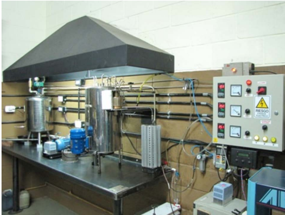
Figura 4: Vista general del tablero eléctrico y sistema de control del equipo
