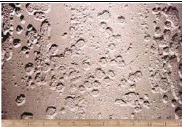
Figura 10 Morfología de picado tipo "lake" (lago) en una muestra procesada en laboratorio con una corriente con contenido en NA pero sin Sulfidico.
