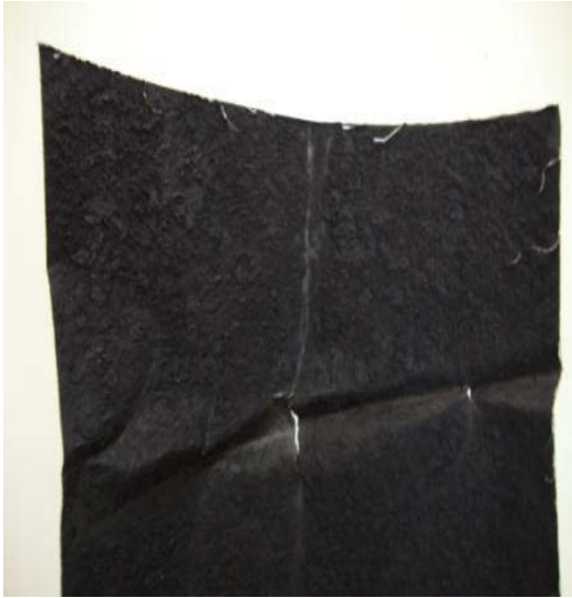
Figura 7. Se observa probable disolución química producida por ácidos nafténicos. 4X.
