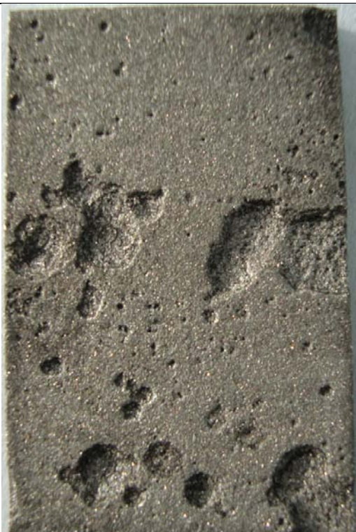
Figura 9 Morfología de picado tipo "lake" (lago) en clad de 12%Cr de virola 4 de la Torre 201 E. Comparar con Fig.10
