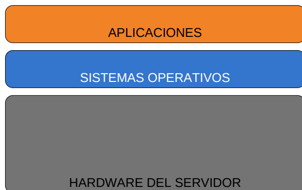
Figura 2. Arquitectura general de un servidor sin Virtualización.
