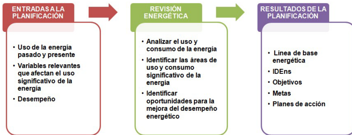
Figura 2) Esquema de la Planificación Energética bajo el enfoque por procesos (2)
