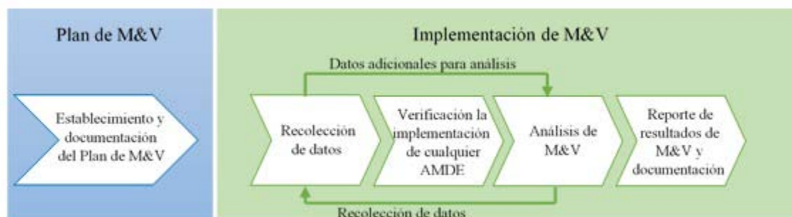
Figura 7) Etapas principales del proceso de M&V (8)
