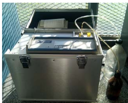
Figura 2: Equipo para la determinación del Código ISO.
