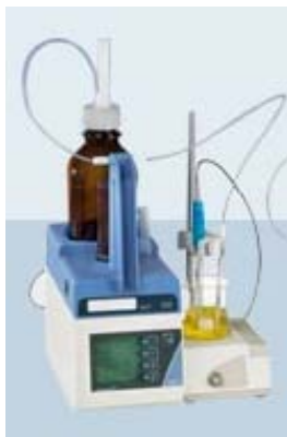
Figura 5: Equipo para la determinación de la acidez.
