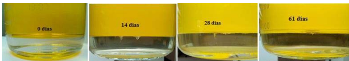
Figura 7: Inspección ocular para el Gasoil Grado 3 contaminado con 10% de agua.
