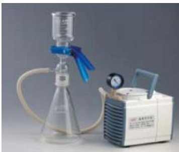
Figura 3: Equipo de filtración para la determinación de la Contaminación total.
