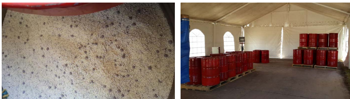
Fig. N°2: Tamizado del catalizador descargado y posterior almacenaje.
