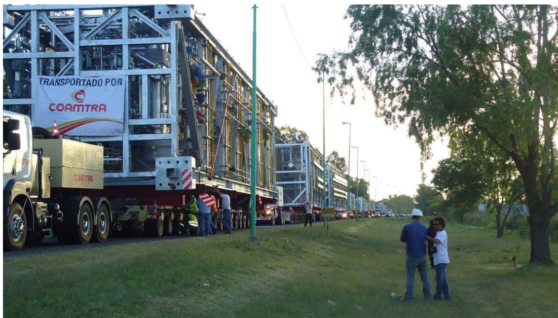
Fig. 3. Módulos de la unidad CCR (Continuous Catalytic Reformer) – Gentileza Odebrecht
