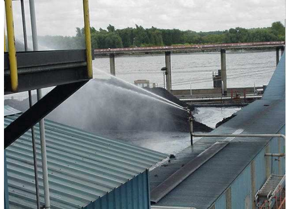
Inyección de surfactante en agua de regado de pila de carbón (2001)
