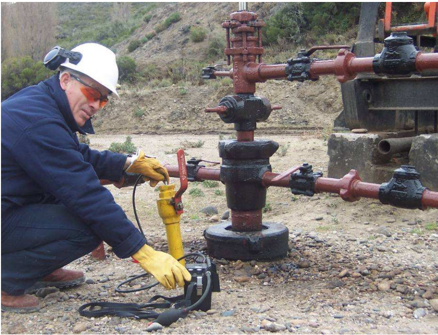
Foto 1. Monitoreo de Metano y Mezcla Explosiva en pozo petrolero.
