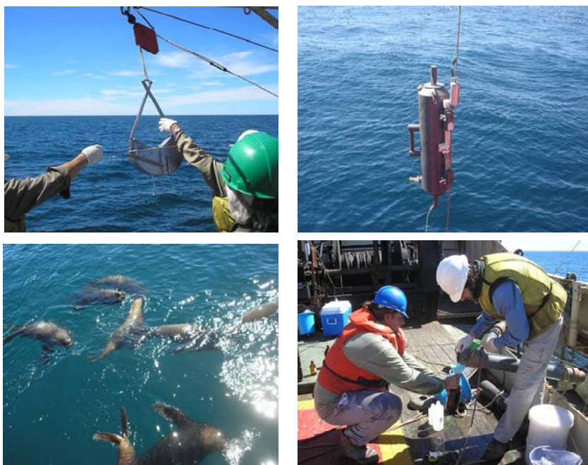
Figura 2: Muestreos realizados durante la campaña marina. Se observa la toma de muestras de sedimento y bentos con draga Van Been, muestreo de agua con botellas Niskin y avistaje de mamíferos marinos.
