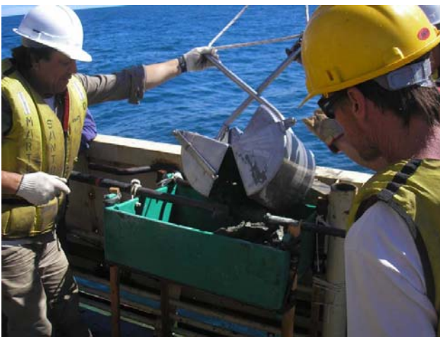
Figura 11: Muestreo de sedimento vaciado en zaranda.
