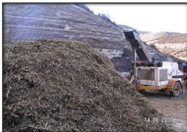
Foto 7: Trituradora utilizada en el tratamiento de los residuos de poda.
