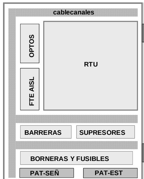
Fig. 27 – Disposición de Interfases en Gabinete de RTU
