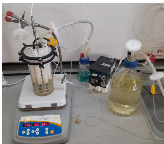
Figura 4. Imagen del reactor CDC en fase continua.
