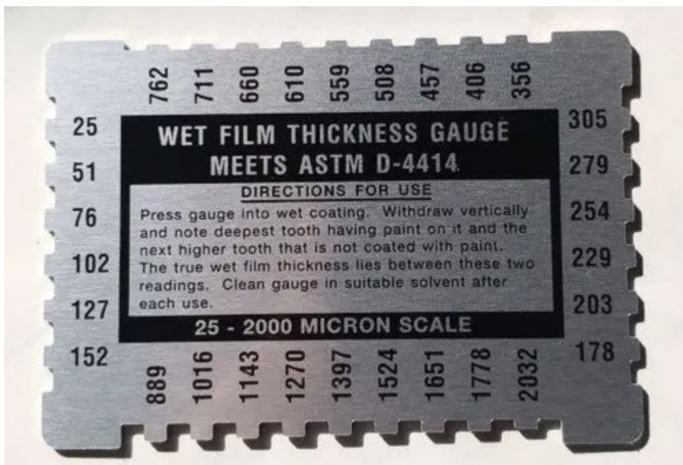
Figura 14: Peine para medición de película húmeda.
