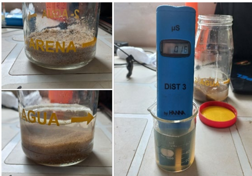
Figura 4: Control de especies iónicas solubles en agua en arena para limpieza abrasiva.
