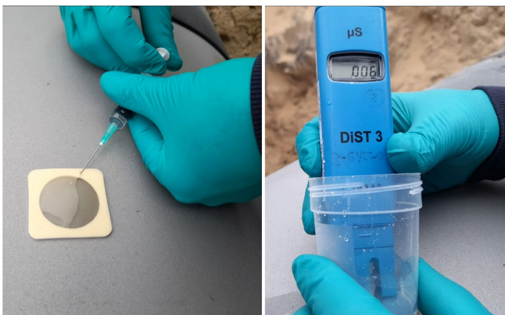
Figura 9: Medición de sales en superficie arenada por método de Bresle.
