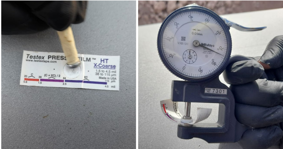
Figura 5: Medición de perfil de anclaje por método de réplica superficial.
