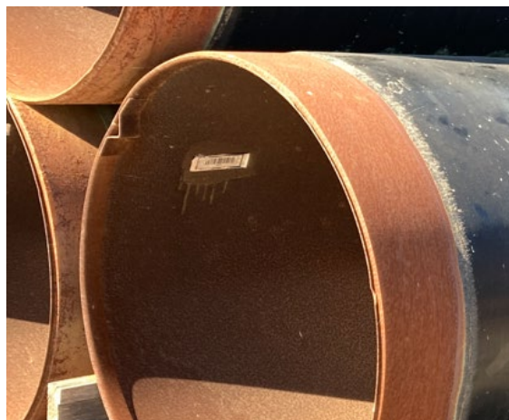
Figura 1. Ejemplo de la colocación de código de barras en la parte interna no revestida.
