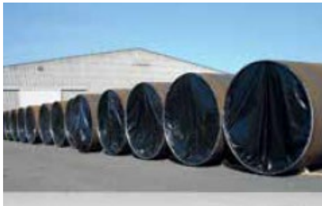
Figura 6. Mantas de PVC para la protección de los extremos en conjunto con protectores metálicos en los extremos.
